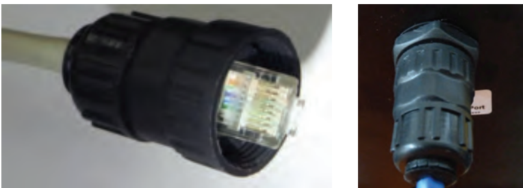
Figura 7.1: Spina RJ45 installata nell'alloggiamento (vista da dietro)
