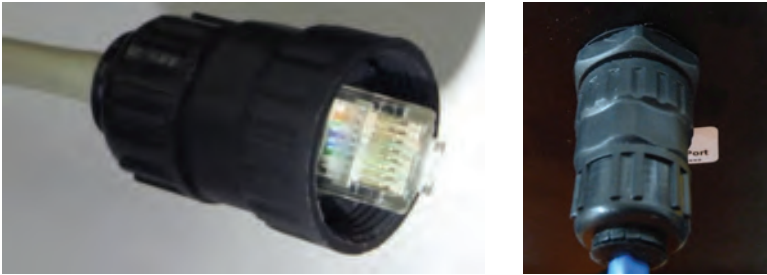
Figura 7.1 Ficha RJ45 instalada na caixa (da retaguarda)
