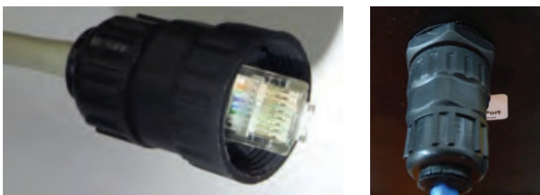
Figura 7.1: Clavija RJ45 instalada dentro de la carcasa (desde la parte trasera)
